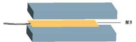
瞬态热线法的理想模型为：在无限大的均匀介质中置入长度无限长的线热源，当二者处于热平衡时，用阶跃恒热流对线热源进行加热，线热源及其周围的被测介质就会产生温升，根据线热源的温升就可以得到被测介质的导热系数，其基本的工作方程为：
